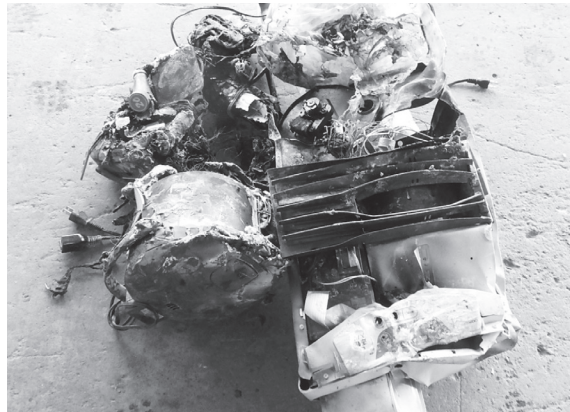
【火災原因の石油ファンヒーター】
